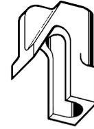
Der Spannhaken besitzt ein Durchgangsloch  $\text{\O}13\text{mm}$  und ist somit für Gewindestäbe M8, M10, M12 geeignet. Gewindestäbe M8 mit Flanschmuttern montieren.
