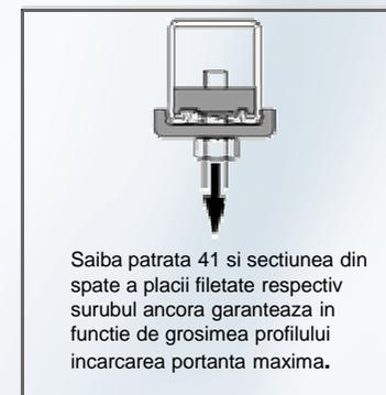
Saiba patrata 41 si sectiunea din spate a placii filetate respectiv surubul ancora garanteaza in functie de grosimea profilului incarcarea portanta maxima.
