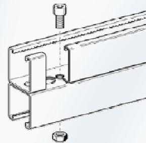
Pentru realizarea profilului dublu pe santier cu surub cap hexagonal M8 x 16 se vor monta tot la 250 mm.
