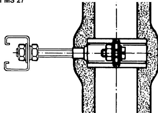
Schraubhalter auf MS 27 mit Gewindestift M8/25 in Block PB 27; Lageeinstellung mit Mutter M8, auch vertikal möglich.
