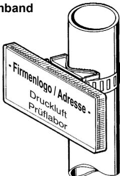
Das mitgelieferte Spannband wird um das Rohr herumgelegt und in die Nasen des Schilderhalters eingehängt. Mit der Mittelschraube wird das Schild am Rohr festgespannt.
