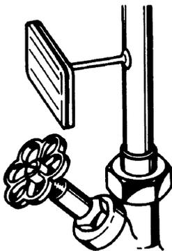
Die Befestigung kann direkt auf der Rohrleitung erfolgen. Für die Montage des Schraubhalters wird eine Rohrschelle mit Gewindeanschluss M8 benötigt.
