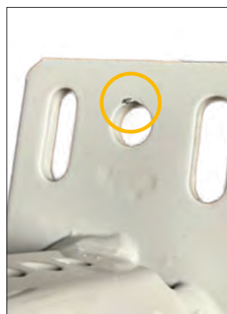
Punct de suspendare după acoperire
